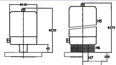
Boîtier étanche IP65 permettant de loger le(s) contact(s) d'alarme. Sortie(s) de câble par connecteur (ou raccords selon besoins) – orientation sur 360°
